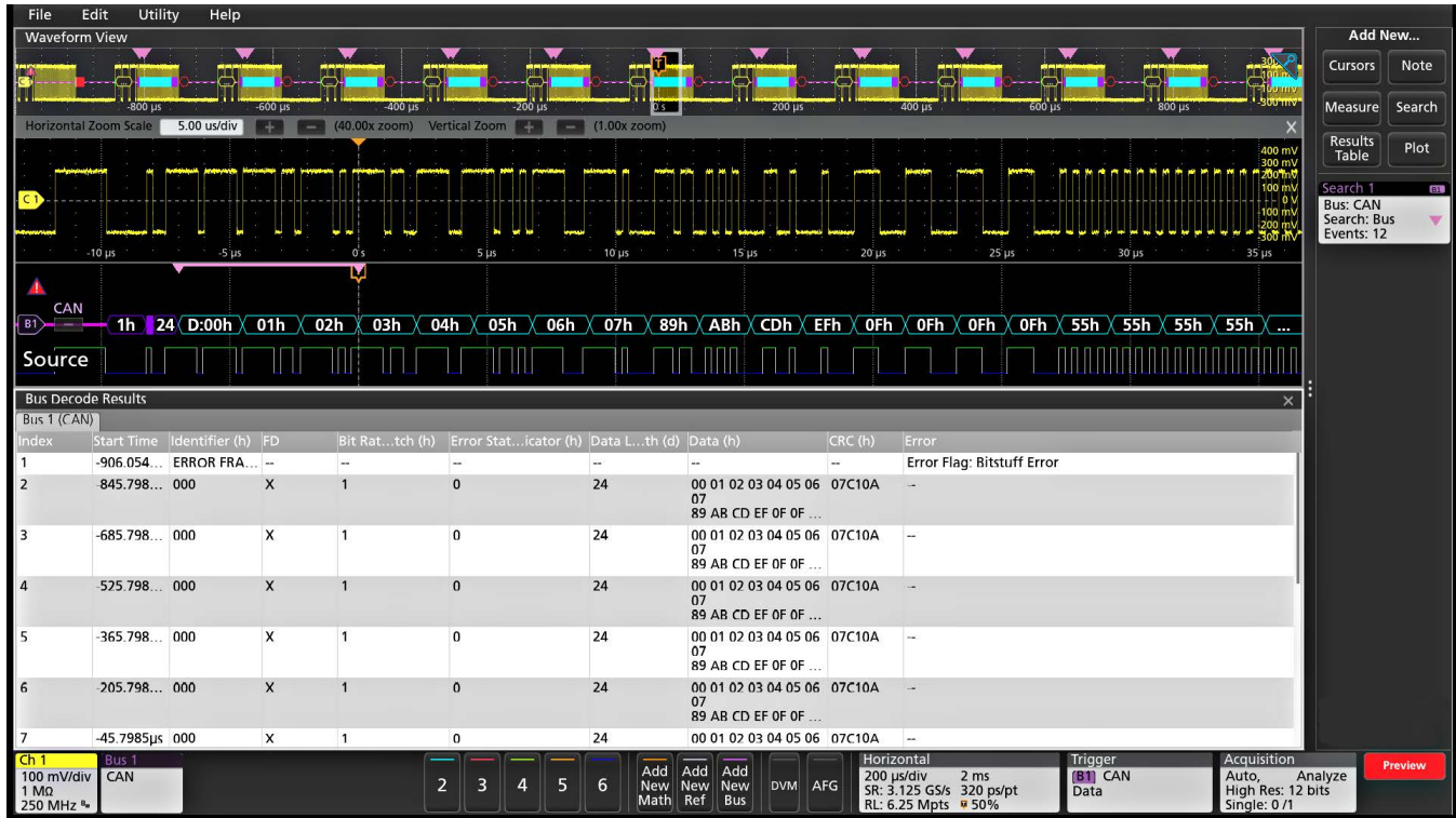
Kích hoạt trên bus nối tiếp CAN. Dạng sóng bus cung cấp nội dung gói được giải mã tương ứng với thời gian bao gồm Bắt đầu, Phân xử, Kiểm soát, Dữ liệu, CRC và ACK trong khi bảng giải mã trình bày tất cả nội dung gói từ toàn bộ quá trình thu nhận.
