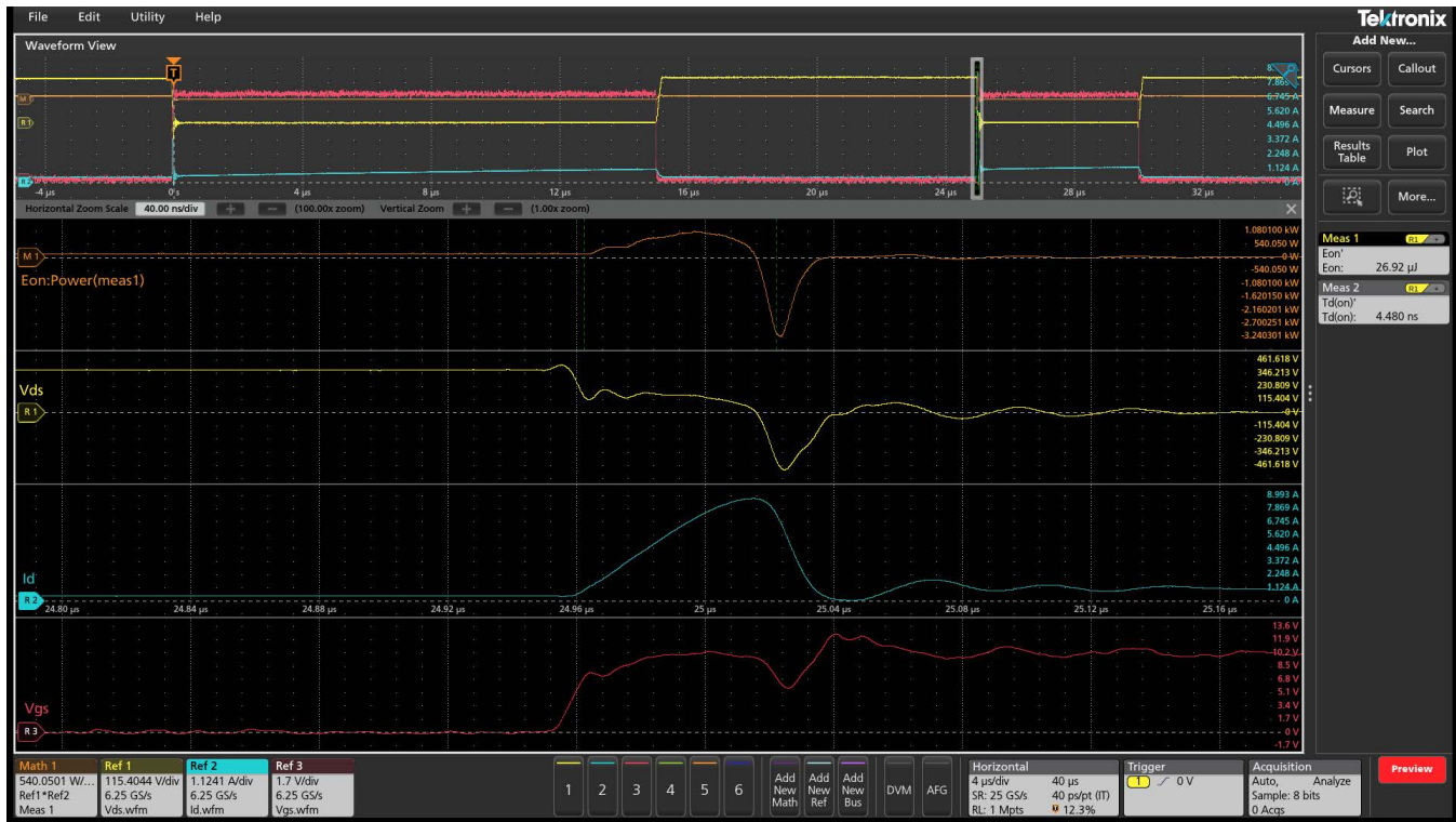
Ảnh cho thấy phép đo khôi phục đảo đi-ốt với điện áp và dòng điện khôi phục đảo được thu nhận ở bên cao.
