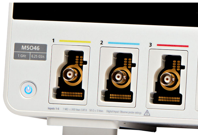
FlexChannel 技术实现了较大的灵活性。依据连接的探头类型，每个输入可以配置成一条模拟通道或 8 条数字通道。
