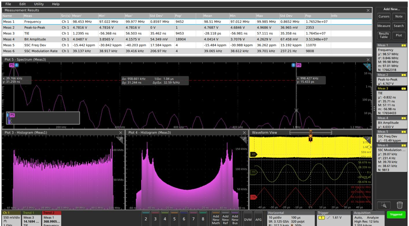
スペクトラム・クロック信号の解析。98MHzのクロックで39kHzの三角波変調が表示されている
