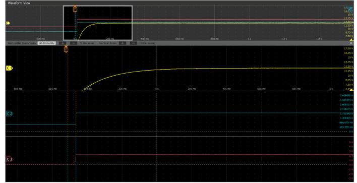
テストをセットアップするには、公称入力/出力電圧、トリガ・レベル、待機時間(期間)を設定します。パワーレール・プリセット・ボタンを押すだけで、最適化プロセスが起動され、最適な結果が得られるようにソフトウェアによってスケール設定、レコード長、サンプル・レートが最適化されます。ターンオン/ターンオフ時間が結果バッジに表示され、色分けされて波形上に示されます。結果は表形式でも表示されます。測定結果表を調べ、異常な値がないか確認し、設計の待機時間を比較し、検証します。
