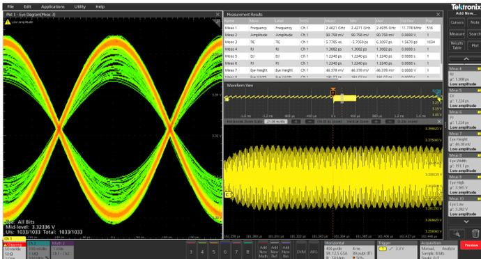
たとえば、SI（シグナル・インテグリティ）エンジニアは、クロックに電力を供給している POL（Point of Load）を測定し、アイ・ダイアグラムを観測して、きれいに開いていることを確認できます。アイ・ダイアグラムがきれいに表示されず、POL からスプリアスが発生していた場合には、より優れた感度が得られるように、PI エンジニアが電源設計を修正する作業に取り組みます。そうすることで、SI エンジニアは HSS 負荷の改善を見ることができます。
