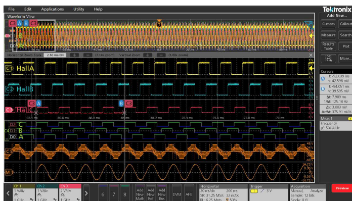
スコープで取得された方向情報は、ホール A、B、C の立ち上がりエッジ・シーケンスを示します (時計回り)。
