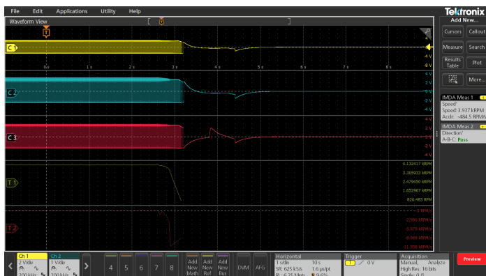
停止状態に移行するモーターの減速を示す時間トレンド・プロット
