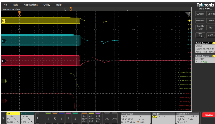
График тенденции во времени, отображающий замедление двигателя в состоянии остановки
