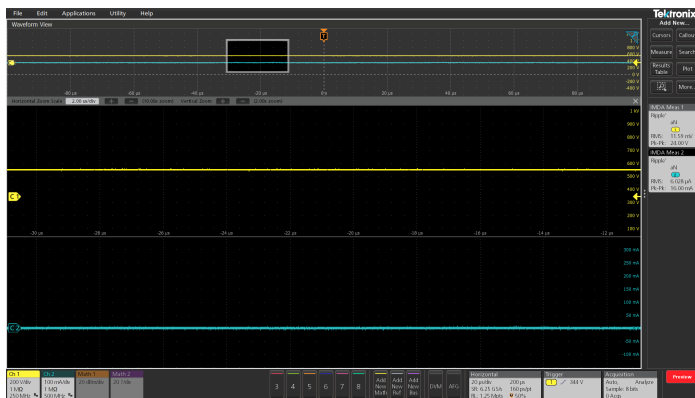
Измерение пульсаций на входных сигналах постоянного тока при проверке преобразователя
