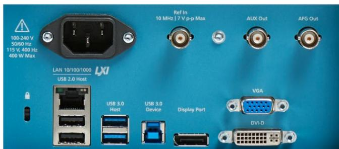
I/O nécessaire pour connecter l'oscilloscope MSO série 5 au reste de l'environnement de conception.
