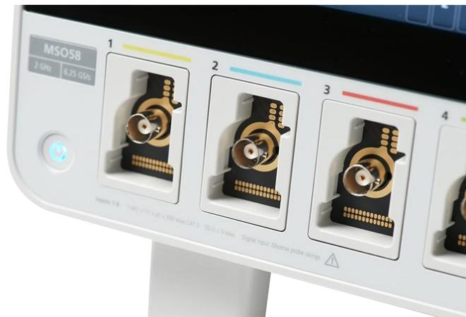
Bénéficiez d'une flexibilité optimale avec la technologie FlexChannel. Chaque entrée peut être configurée pour une voie analogique ou huit voies numériques, suivant le type de sonde utilisé.
