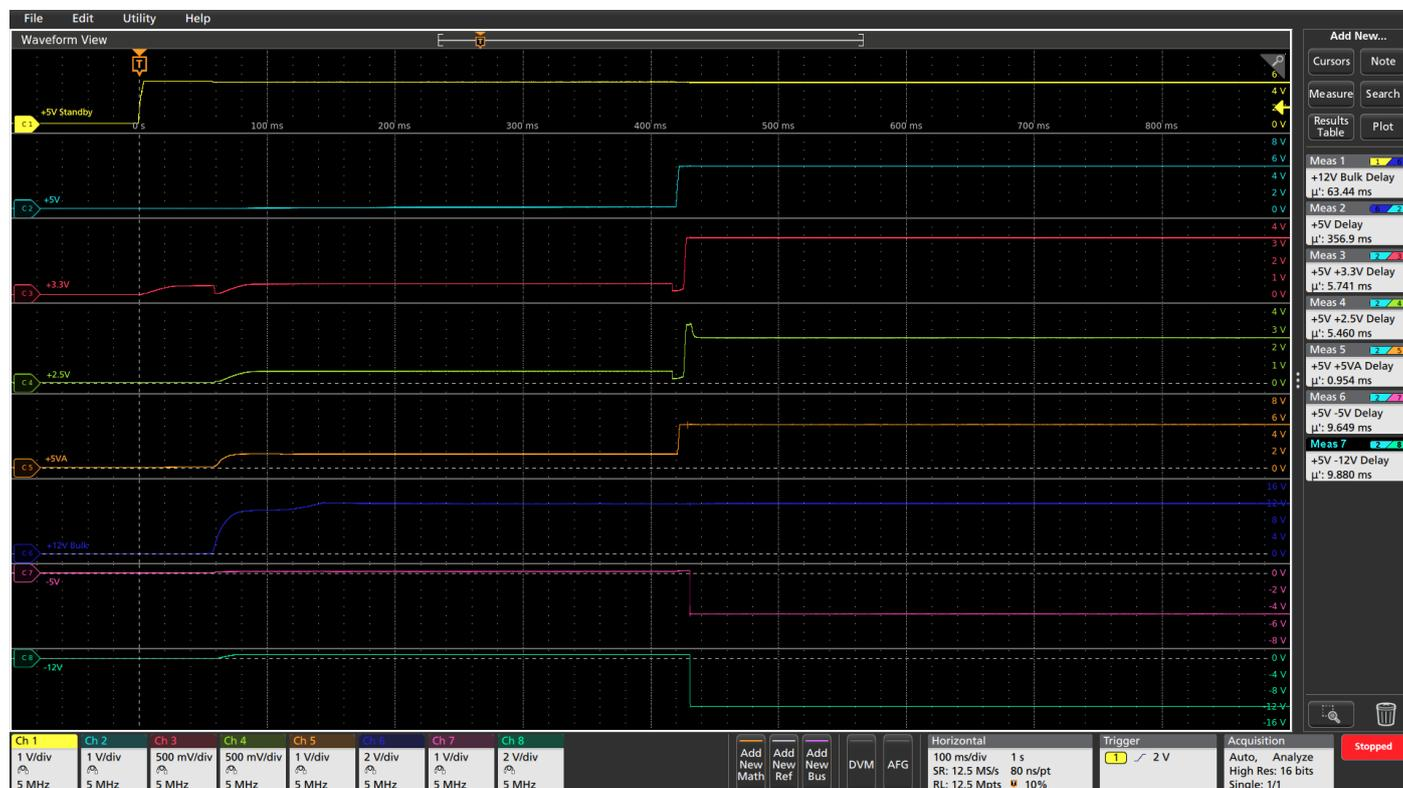
Utilisation de mesures automatisées pour caractériser l'augmentation de l'alimentation électrique.
