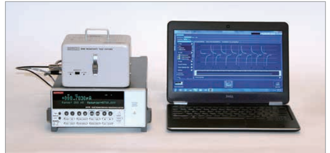
6517B型エレクトロメータ／絶縁抵抗計、8009型抵抗率テスト・フィクスチャ、KickStart高抵抗率測定アプリケーションによる、ASTM D-257に準拠した高抵抗率テスト・システム
