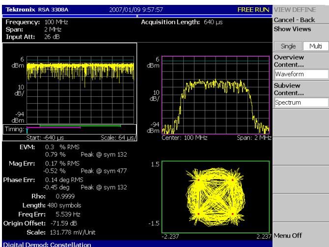
Измерение амплитуды вектора ошибки и констеляционная диаграмма
