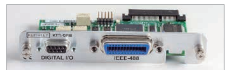
KTTI-GPIB型GPIBインタフェースと6つのデジタルI/Oポート
