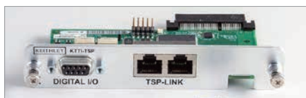
KTTI-TSP型TSP-Linkインタフェースと6つのデジタルI/Oポート
