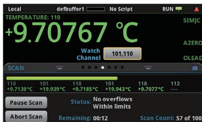
DAQ6510型のスキャン・ステータス画面により、テストの状態がすばやく、簡単にモニタできる
