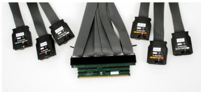
TLA シリーズ・ロジック・アナライザと多チャンネル信号取込み用のプローブ
