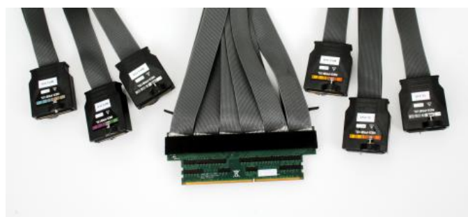
TLA 逻辑分析仪和探头，支持多通道信号捕获
