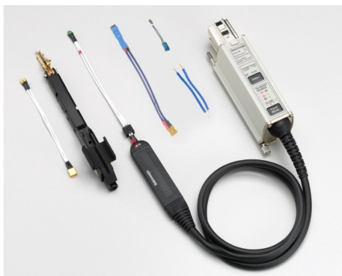
P7500 系列 Trimode™ 探头系统, 带附件
