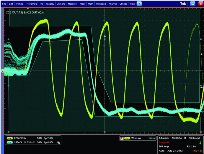
Mémoire DDR. Déclenchement visuel utilisé pour isoler une occurrence rare d'une rafale d'écriture sur un modèle de bits spécifique dans DDR3. L'événement de déclenchement est une rafale DQ d'écriture de 11000000, lorsque le lancement DQ commence à partir d'une valeur de tension non triétatique. Les événements de bus de mémoire DDR impliquent des horloges, des signaux stroboscopiques et des canaux de données, ainsi que plusieurs amplitudes et rafales de données.
