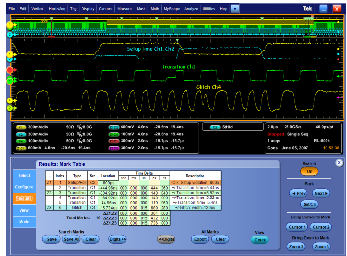
Recherche et marquage avancés : met en évidence les événements importants et permet de naviguer facilement entre les événements intéressants à l'aide des boutons Précédent et Suivant et en cliquant avec la souris.
