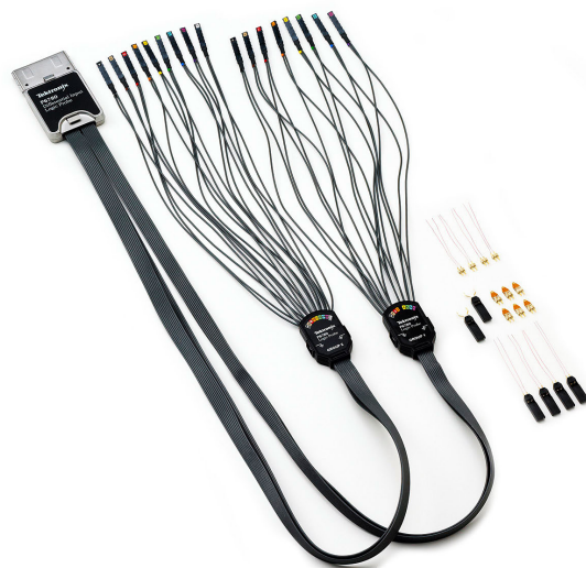
Die Differential-Logikastköpfe P6780 bieten Anschlüsse mit hoher Bandbreite für bis zu 16 digitale Signale.
