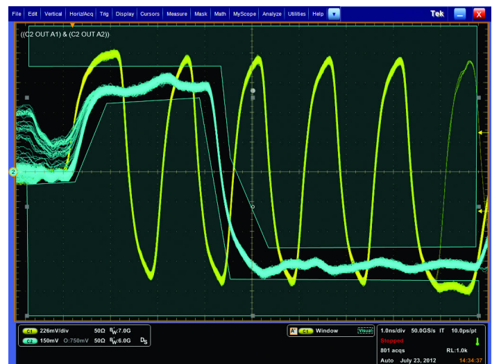
DDR-Speicher. Visueller Trigger zum Isolieren eines selten auftretenden Schreib-Bursts in einem bestimmten Bitmuster im DDR3. Bei dem Trigger-Ereignis handelt es sich um einen DQ-Schreib-State 11000000 zu Beginn des DQ-Aufrufs von einem Non-Tri-State-Spannungswert. DDR-Speicherbus-Ereignisse umfassen Takte, Strobes und Datenkanäle sowie Mehrfach-Amplituden und Daten-Bursts.
