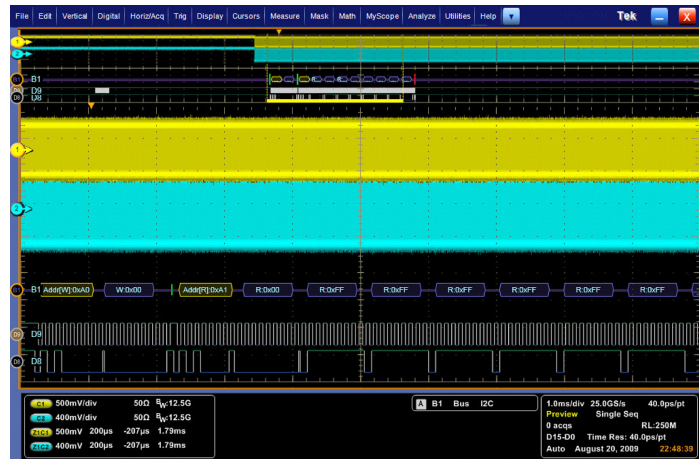
同期のある高速信号と低速信号を 25 GS/s で 10 ms 間取込んだ例。
