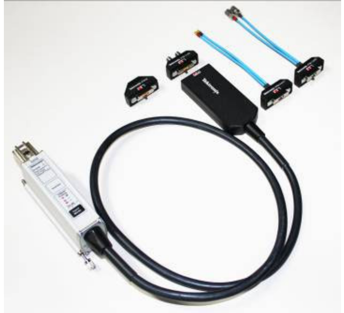
P7633 낮은 노이즈 TriMode 프로브가 복잡한 측정 설정을 간소화합니다.
