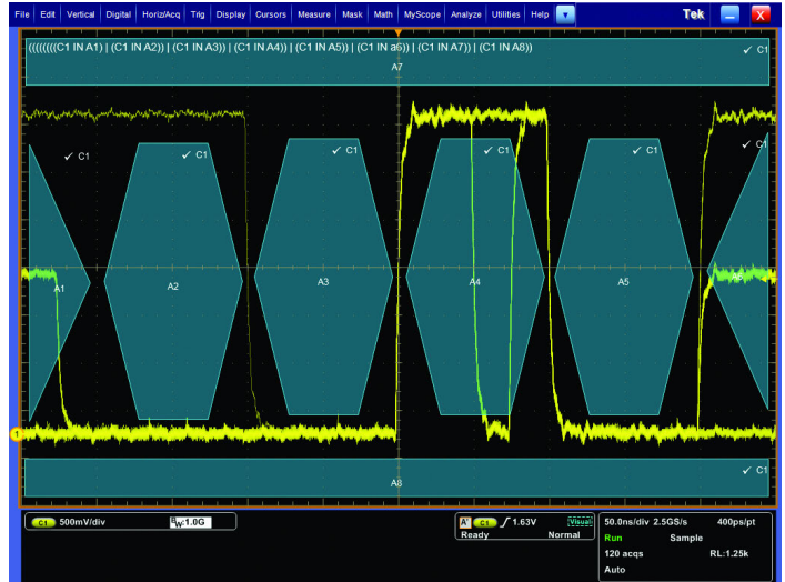
布林邏輯觸發資格。使用邏輯 OR 的布林邏輯可讓使用者同步監控每個位元，在擷取資料的任一點擷取異常事件。
