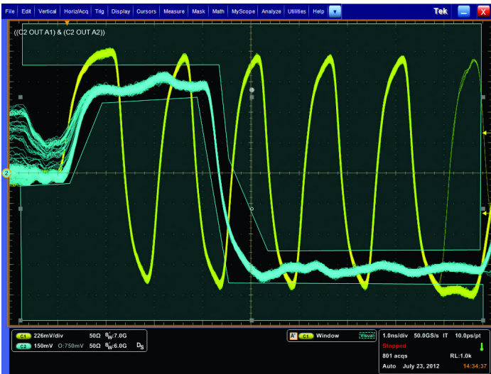
DDR 記憶體。用來在 DDR3 的特定位元碼型上隔離罕見寫入叢發的視覺觸發。觸發事件是 11000000 的 Write DQ 叢發 (DQ 啟動始於非三態電壓值)。DDR 記憶體匯流排事件涉及時脈、選通、資料通道，以及資料的多重振幅和叢發。
