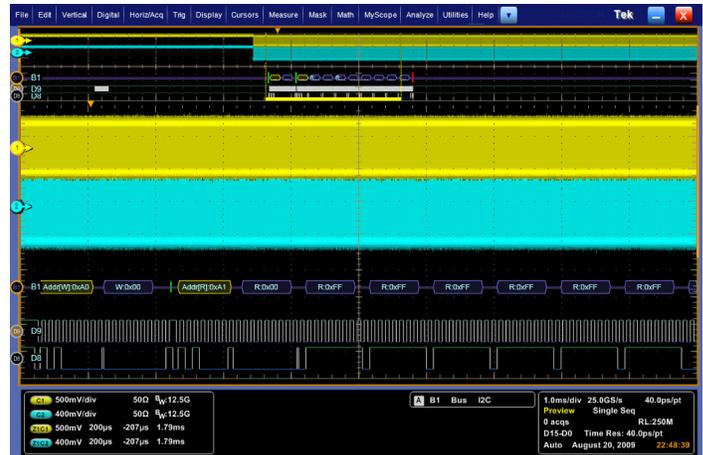
10 ms lange Erfassungsdauer von synchronen Hochgeschwindigkeits- und Niedriggeschwindigkeitssignalen mit 25 GS/s.
