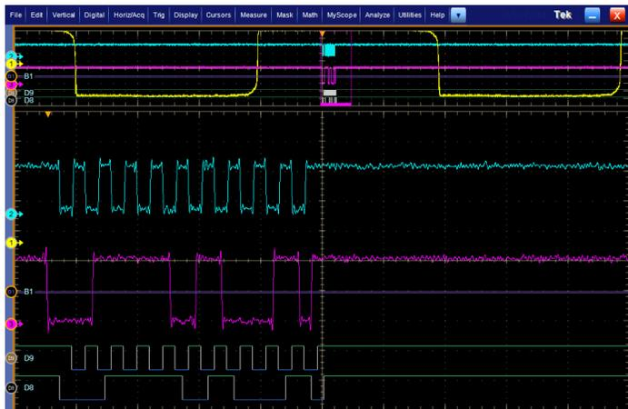
Integrierte Logikkanäle – bieten zeitkorrelierte analoge und digitale Sichtbarkeit für das Debugging des Systems.
