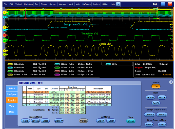
拡張イベント・サーチ／マーク - 重要なイベントをハイライト表示し、左右の矢印ボタンとマウス・クリックにより、イベント間を簡単に移動できる
