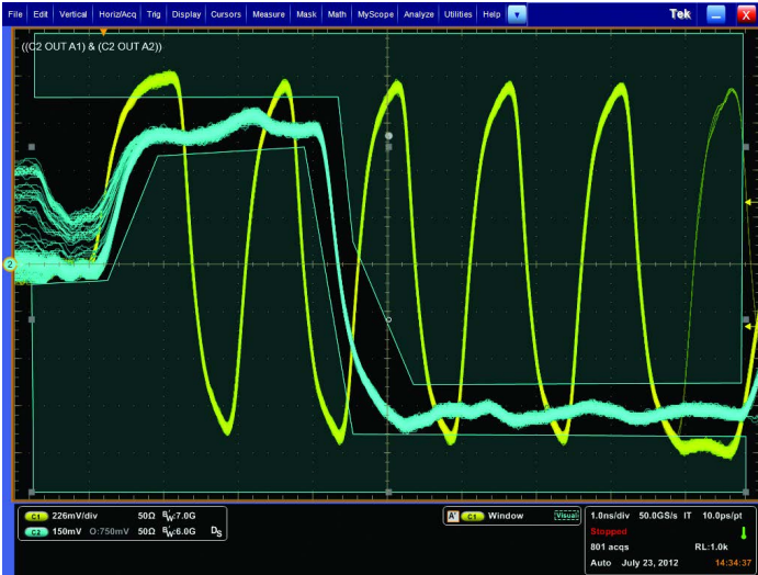
DDR メモリの例。ビジュアル・トリガを使用し、DDR3 の特定のビット・パターンにおける、めったに発生しない書き込みバーストを分離した例。トリガ・イベントは、DQ ローンチが非トライステートの電圧値からスタートする、11000000 の書き込み DQ バースト。DDR メモリ・バスのイベントには、クロック、ストロブ、データ・チャンネル、複数のデータの振幅とバーストが含まれる
