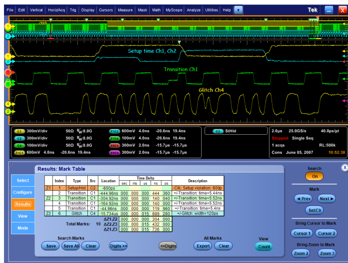
高级事件搜索和标记 – 突出显示重要事件，提供方便的“上一个”和“下一个”按钮，鼠标单击即可轻松浏览感兴趣的事件。
