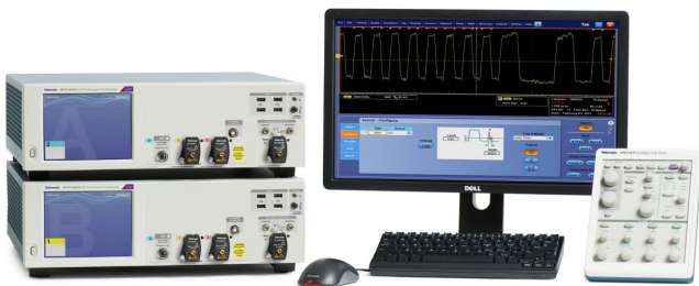
2 x 70 GHz, 4 x 33 GHz Konfiguration mit Monitor und zusätzlichem vorderen Bedienfeld
