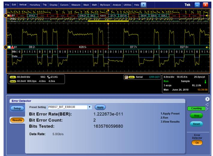
位元錯誤偵錯器 (選項 BITERR) - 提供有關計數位元與偵測到的錯誤數的統計資料，並在偵測到位元錯誤時顯示波形資料。如圖所示，位元錯誤偵測器可與選用串列資料解碼器組合，以便偵錯及診斷錯誤。
