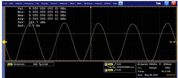
此功能提供進行高精度時脈穩定性量測的能力。在顯示的螢幕擷取中，於 8 GHz 精確訊號源上測量到 212  $\mu$ Hz 的訊號源游離偏差。在此圖中，訊號產生器設定為 8.0000000001 GHz，且示波器精確量測了該數量。
