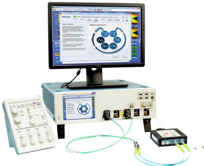
SignalCorrect 可使用 TCS70902 快速步驟來源和 DPO7000SX 系列即時示波器上擷取的響應來執行纜線、治具和其他互連類型的快速特性分析。
