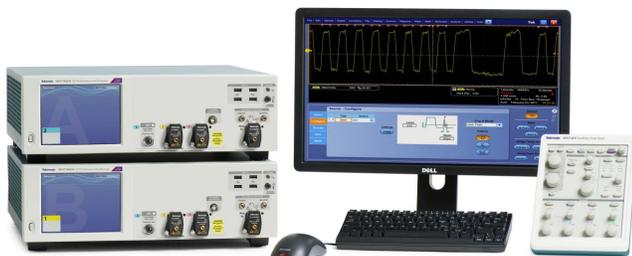
2 x 70 GHz、4 x 33 GHz 組態，具有監視器與輔助前面板
