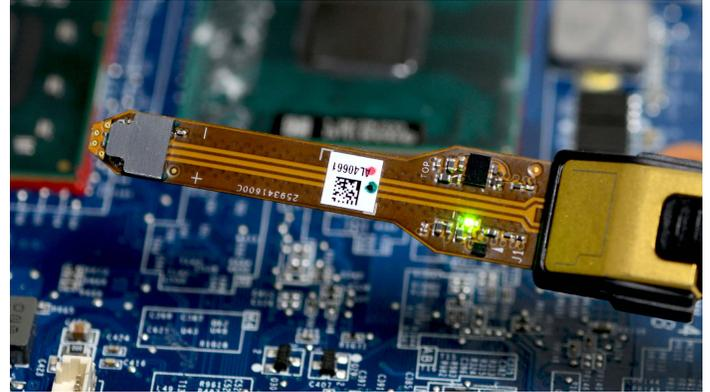
P77STFLXA 焊接式彈性電路配件的尖端配備主動式緩衝區放大器，可提供高達 20 GHz 的頻寬。
