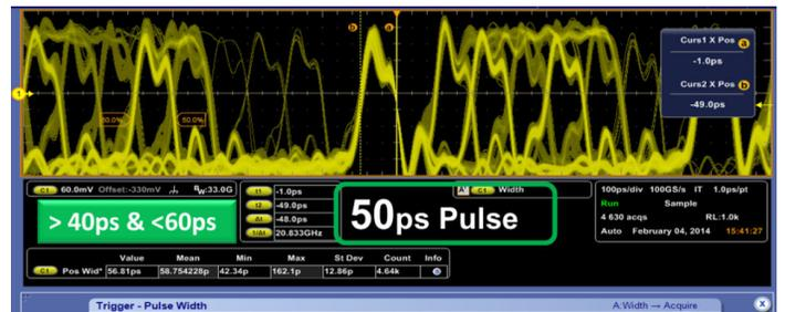
DPO70000SX 包括唯一一包封觸發模式，可直接觸發調變載波的包封。邊緣、寬度與逾時觸發類型可套用至偵測到的包封，以提供調變脈衝的穩定觸發或區分特定寬度的脈衝。載波頻率可以在 500 MHz 到 20 GHz 的範圍內，以滿足廣泛應用。該圖說明特定寬度脈衝的觸發。
