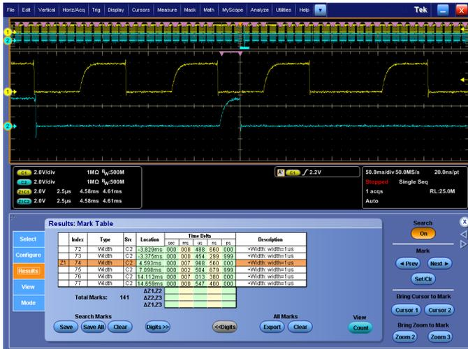
Второй этап поиска. Функции расширенного поиска и маркировки событий позволяют автоматически просматривать запись и помечать найденные события цветными треугольниками. Теперь можно перемещаться между событиями с помощью кнопок Previous (Назад) и Next (Вперед).
