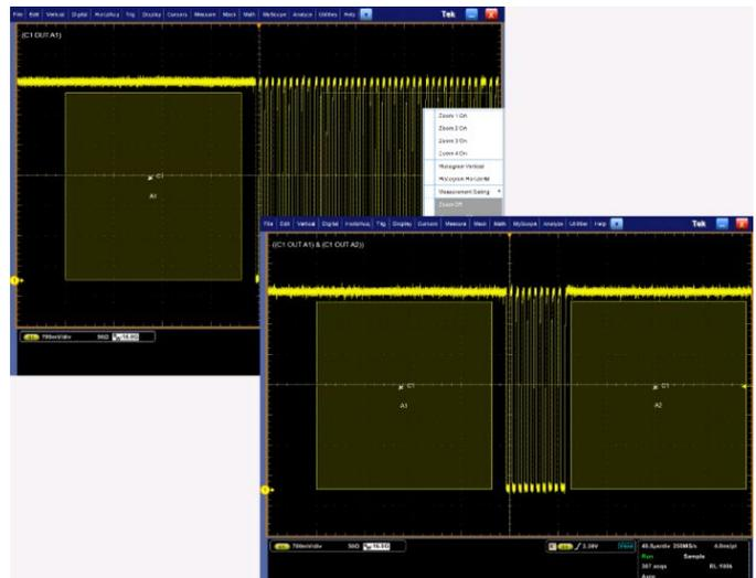
Запуск по пакету, состоящему из 10 импульсов. Выделяя одну запрещенную зону до первого тактового импульса и вторую запрещенную зону после десятого импульса, как показано на рисунке, вы можете настроить визуальный запуск, при котором захватывается пакет требуемой длительности.
