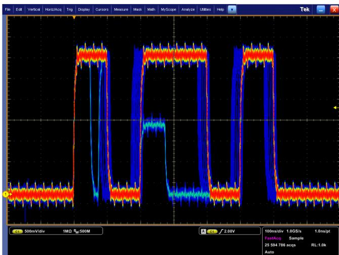
Технология цифрового люминофора осциллографов серии DPO7000C поддерживает скорость захвата более 250 000 осциллограмм в секунду и отображение градаций яркости в режиме реального времени.
