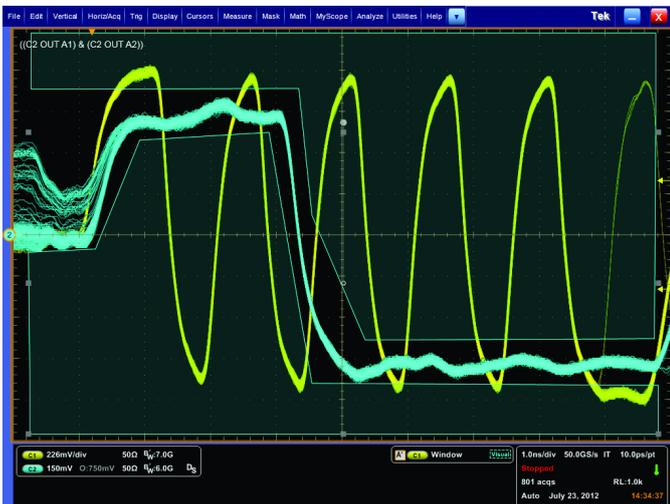
Шина памяти DDR. Визуальный запуск используется для выделения неперiodических событий в пакетах записи по определенной последовательности битов в памяти DDR3. Событием для запуска является пакет записи DQ (код 11000000), если сигнал DQ начинается с напряжения, отличного от любого из трех состояний. К сигналам шины памяти DDR относятся сигнал тактовой частоты, стробирующие импульсы и пакеты данных, имеющие разную амплитуду.
