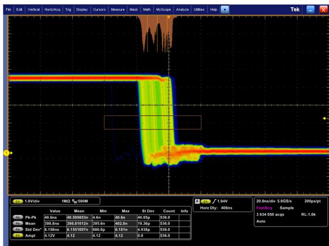
Анализ: гистограмма сигнала, построенная по спаду импульса, помогает оценить зависимость положения перепада от времени (джиттер). На экране отображаются числовые значения результатов измерений, полученные на основе гистограммы. Всеобъемлющий набор встроенных средств анализа ускоряет проверку характеристик тестируемого устройства.
