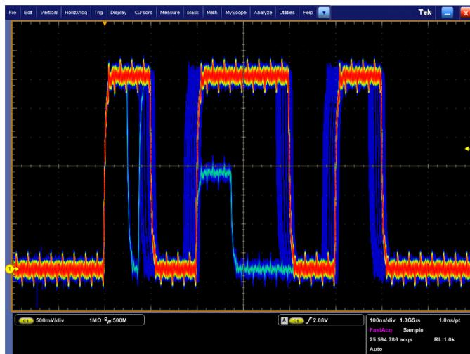
Обнаружение неисправности. Захват сигнала со скоростью более 250 000 осциллограмм в секунду максимально повышает вероятность обнаружения кратковременных глитчей и других редко появляющихся событий.
