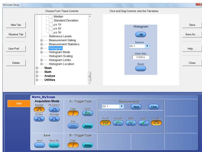
Настраиваемые окна управления MyScope создаются при помощи простой функции "перетаскивания" мышью, позволяя каждому пользователю работать со своим уникальным интерфейсом.
