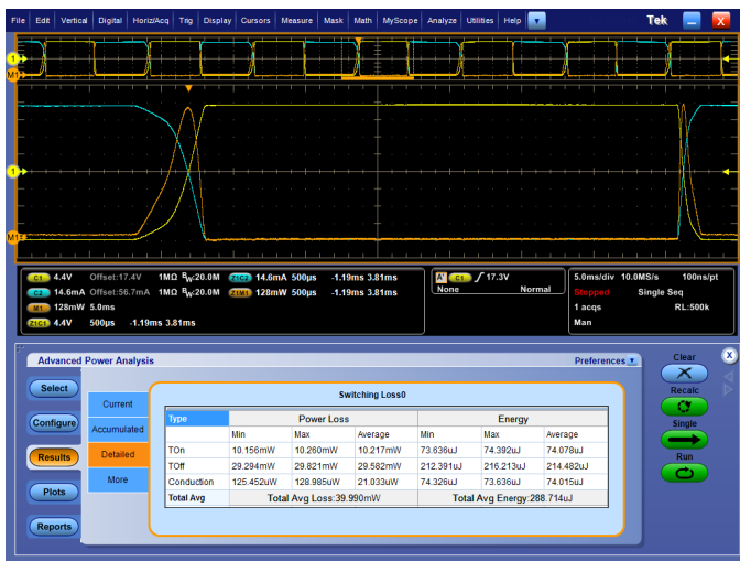
切換損耗量測。自動功率量測可快速且準確地分析一般功率參數。
