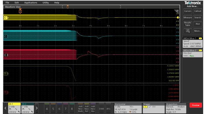
停止状態に移行するモーターの減速を示す時間トレンド・プロット
