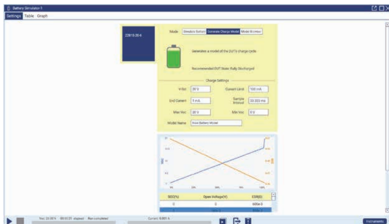
1回のマウス・クリックで、新しいカスタム・バッテリー・モデルの作成、保存が可能
