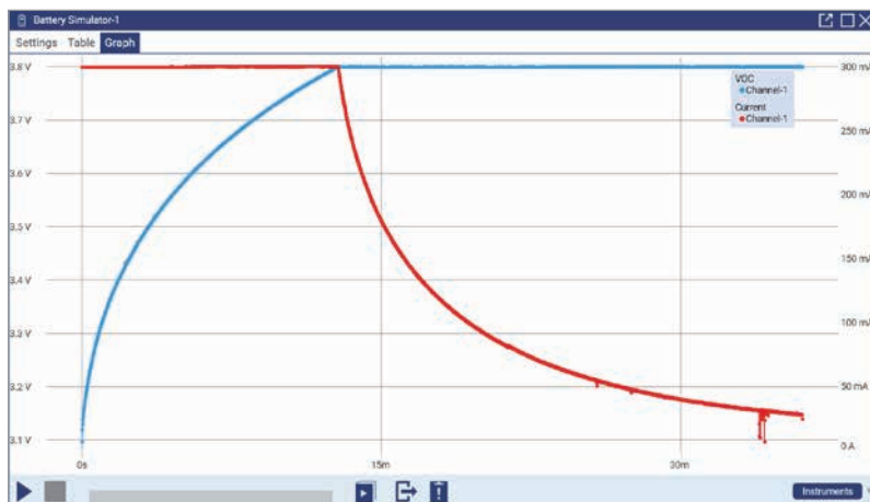
モデル生成時、収集される VOC、電流、または ESR の読み値を表示
