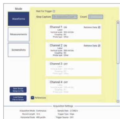
セットアップ・ウィンドウで波形、測定、またはスクリーンショットのモードが選択可能
