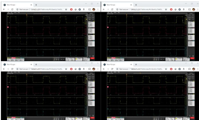
Vous pouvez facilement commander à distance plusieurs instruments à l'aide d'e*Scope en utilisant différents onglets de navigateur.
