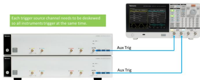
Synchronisation de voies d'instrument multiples dans un délai de 200 ps, grâce à la compensation manuelle et à l'entrée de déclenchement auxiliaire Aux Trigger
