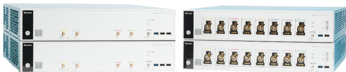
两台 6 系列紧凑型数字化仪模数转换器(左)和两台 5 系列 MSO 紧凑型数字化仪示波器(右)
