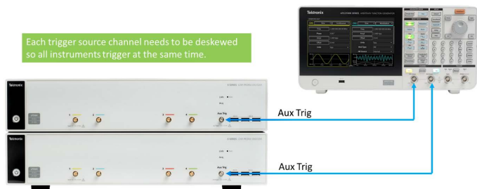
使用手动时延校正和辅助触发输入，在 200 ps 内同步多条仪器通道
