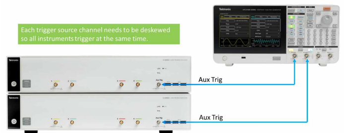
手動デスクューおよび外部トリガ入力を使用することで、複数の機器のチャンネルの同期が可能 (200ps 以内)
