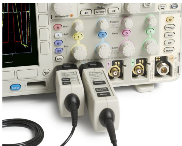
TekVPI プローブ・インタフェースにより、オシロスコープとプローブの接続が簡単
