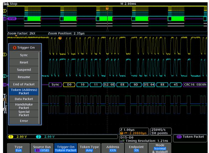
Triggerung auf ein bestimmtes OUT-Token-Paket an einem seriellen USB-Full-Speed-Bus. Das gelbe Signal steht für D+, das blaue steht für D-. Ein Bussignal umfasst den dekodierten Paketinhalt, einschließlich Start, Sync, PID, Adresse, Endpunkt, CRC, Datenwerte und Stop.
