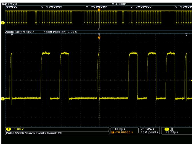
Suchen Schritt 2: Wave Inspector durchsucht automatisch die Aufzeichnung und markiert jedes Ereignis mit einem leeren, weißen Dreieck. Mit den Zurück- und Weiter-Schaltflächen gelangen Sie von einem Ereignis zum nächsten.
