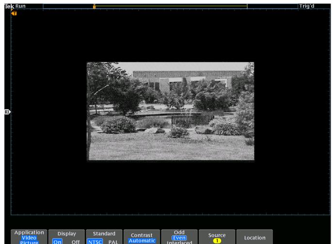
Anzeigen von NTSC-Videosignalen. Der Videobild-Modus verfügt über automatische Kontrast- und Helligkeitseinstellungen sowie manuelle Bedienelemente.
