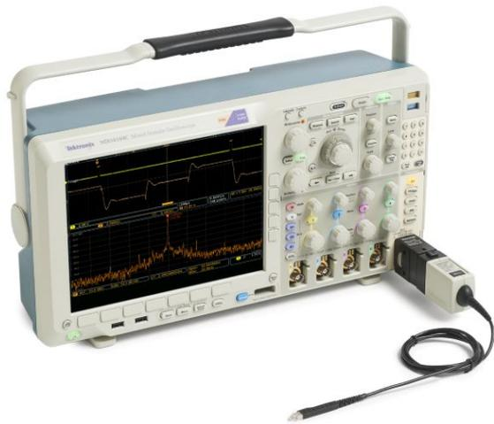
Mit dem optionalen TPA-N-VPI-Adapter kann jeder aktive 50- $\Omega$ -TekVPI-Tastkopf an den HF-Eingang angeschlossen werden.
