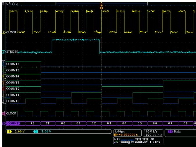
Die Geräte der Baureihe MDO4000C bieten 16 integrierte Digitalkanäle zur Anzeige und Analyse zeitkorrelierter Analog- und Digitalsignalen.
