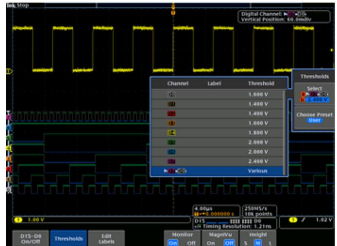
Durch die farbkodierte Anzeige von digitalen Signalen werden Gruppen gebildet, indem digitale Kanäle auf dem Bildschirm einfach nebeneinander angeordnet werden und als Gruppe verschoben werden können.
