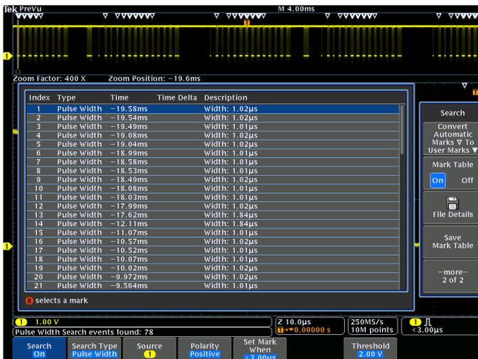
Suchen Schritt 3: Die Tabelle mit Suchmarkierungen bietet eine Tabellenansicht der bei der automatischen Suche gefundenen Ereignisse. Jedes Ereignis wird mit einer Zeitmarke angezeigt und erleichtert dadurch die Messung von Zeitunterschieden zwischen den Nachrichten.
