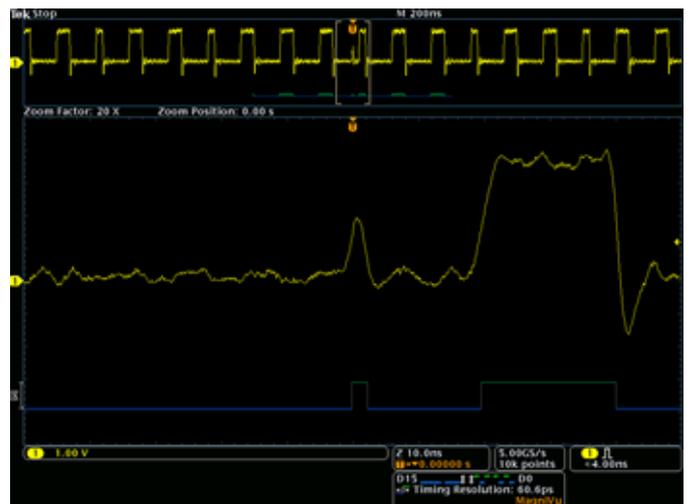
L'enregistrement haute résolution MagniVu affiche une résolution temporelle de 60,6 ps, ce qui permet d'effectuer des mesures temporelles précises sur vos signaux numériques.
