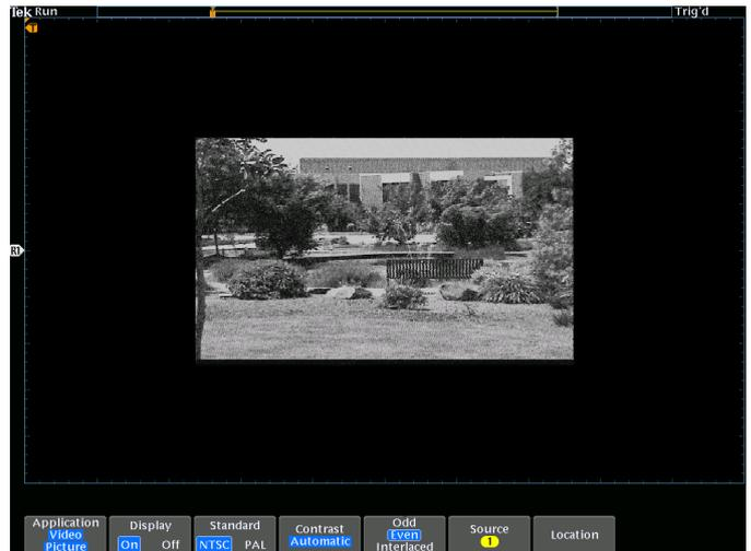
Affichage d'un signal vidéo NTSC. Le mode image vidéo effectue les réglages automatiques de contraste et de luminosité et comporte des commandes manuelles.
