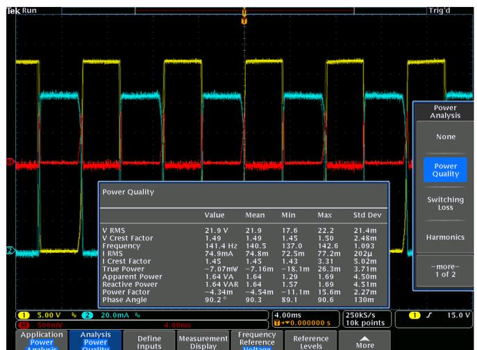
Mesures de la qualité de l'alimentation. Les mesures automatiques de puissance permettent d'analyser rapidement et précisément les paramètres courants des alimentations.
