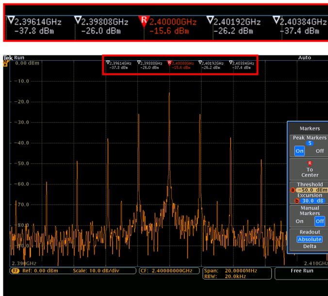
Les marqueurs automatiques de pics permettent d'identifier immédiatement les informations importantes. Sur la figure, les cinq pics de plus grande amplitude remplissant les conditions de seuil et d'excursion sont automatiquement marqués en même temps que leur fréquence et leur amplitude.
