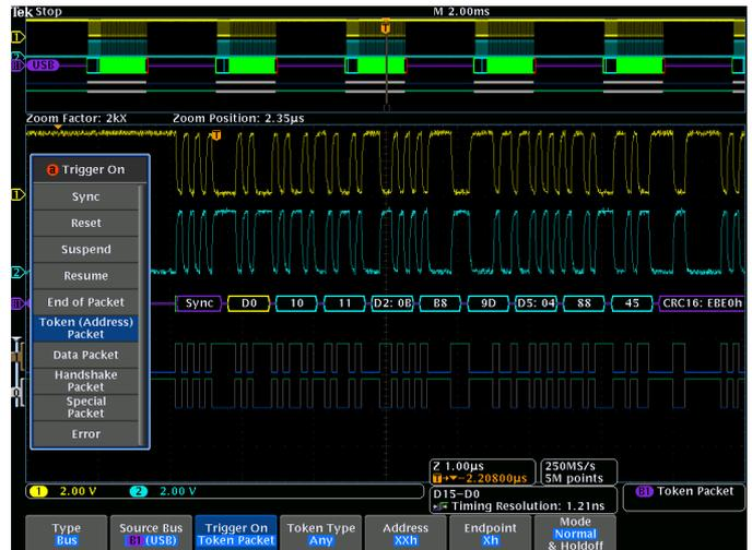
Déclenchement sur un paquet jeton OUT spécifique sur un bus série USB haut débit. Le signal jaune représente D+ et le bleu D-. Le signal du bus fournit le contenu du paquet décodé incluant les valeurs Départ, Sync, PID, Adresse, Point final, CRC, Données et Arrêt.
