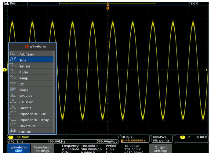
Sélection du type de signal dans le générateur de signaux intégré (AFG).
