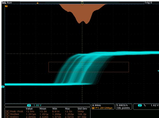
Histogramme du front montant d'un signal montrant la répartition de la position du front (gigue) dans le temps. Les mesures numériques effectuées à partir des données de l'histogramme de signaux sont incluses.
