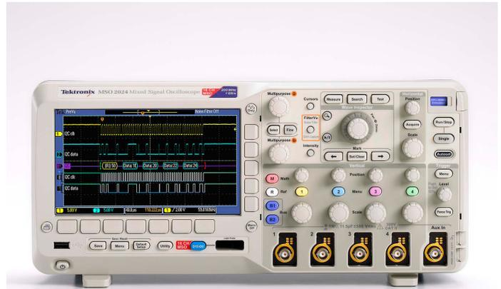
Die Oszilloskope der MSO/DPO2000-Serien sollen Ihnen die Arbeit erleichtern. Auf dem hellen, breitformatigen Display wird ein großes Zeitfenster angezeigt. Fest zugeordnete Bedienelemente auf dem Frontpaneel garantieren eine unkomplizierte Bedienung. Über den USB-Anschluss auf dem Frontpaneel lassen sich Bildschirmhalte, Geräteeinstellungen und Signaldaten mühelos auf einen Speicherstick übertragen.
