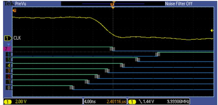
Weißer Flanken bedeuten, dass zusätzliche Informationen verfügbar sind, wenn die Erfassung mit einer höheren Abtastfrequenz durchgeführt wird.
