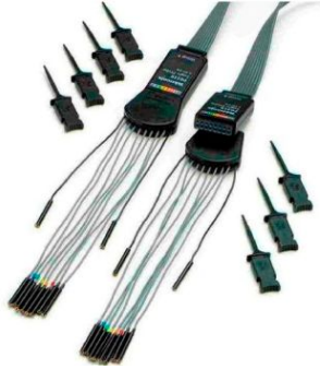
P6316 MSO 探棒提供兩組 8 通道 pod，可簡化與裝置連接的方式。
