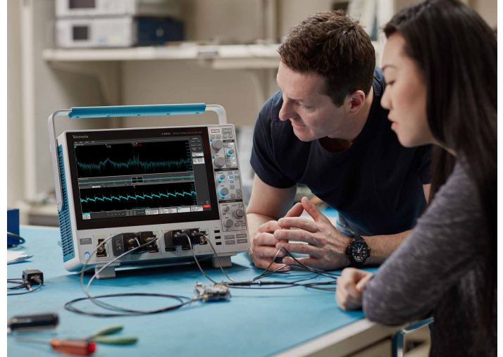
スイッチング電源での電圧測定。パワーレールの 1 つでリップル電圧を測定し、表示している
