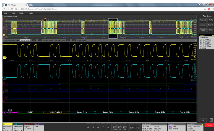
図 33: e*Scope を使用すれば、一般的な Web ブラウザを使用して、手軽にリモート表示と制御が行える
