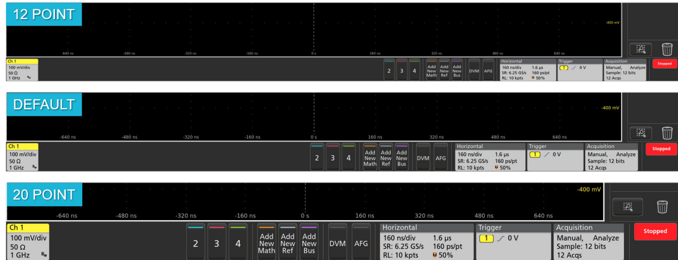
図10: フォント・サイズに応じてユーザ・インタフェースも連動する
