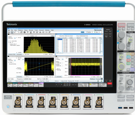
図 28 : SignalVu-PC によるパルス解析 (5 シリーズ)
