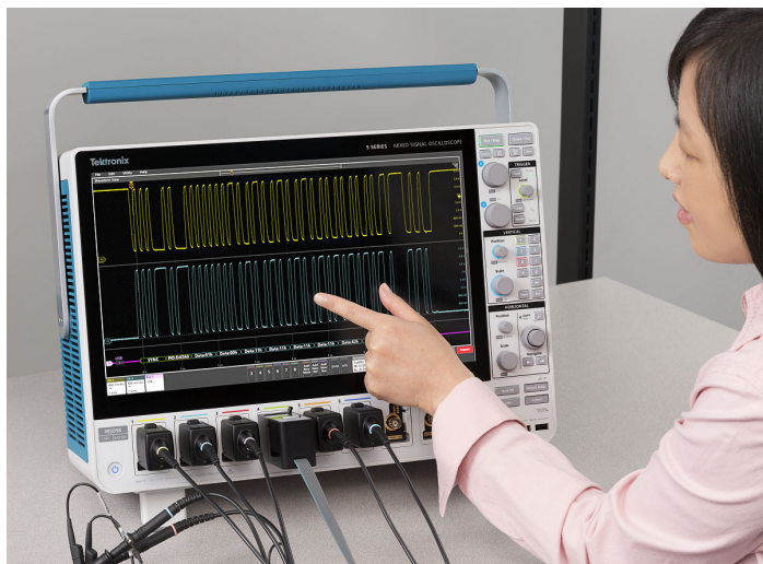
図9: スマホやタブレットと同じ静電容量方式のタッチスクリーンを使用して操作が行える
