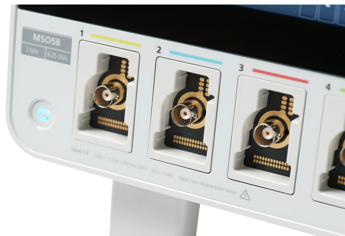
図2: 優れた柔軟性を実現した FlexChannel 技術では、接続するプローブの種類により、1つのアナログ・チャンネルとして使用するか、8つのデジタル・チャンネルとして使用するかを柔軟に選択できる
