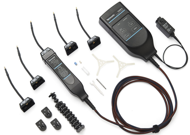
図18: テクトロニクス社の TIVM シリーズ IsoVu™ 測定システムは、全帯域でクラス最高の同相除去性能を実現したガルバニック絶縁測定ソリューションであり、大きなコモンモード電圧が存在する条件でも、最大 2,500Vpk の広帯域差動信号が正確に分離可能
