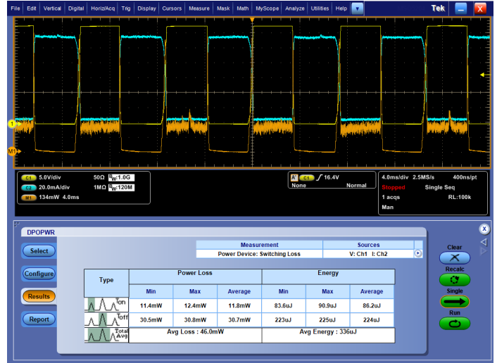
Schaltverlustmessungen. Automatische Leistungsmessungen ermöglichen die schnelle und genaue Analyse von wichtigen Leistungsparametern.
