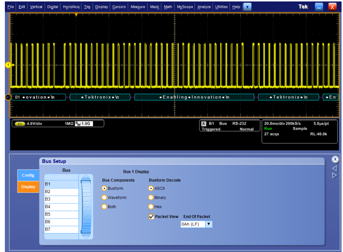
Paket-Ansicht dekodierter RS-232-Meldungen.
