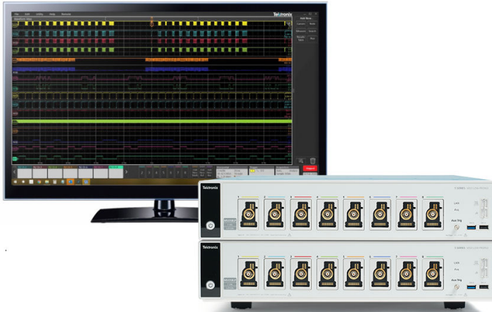
Анализ на ПК сигналов от двух приборов MSO58LP при помощи опции Multi-Score ПО TekScope
