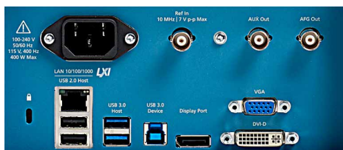
Входы и выходы, которые нужны для подключения осциллографа MSO Серии 5 к испытательному оборудованию.
