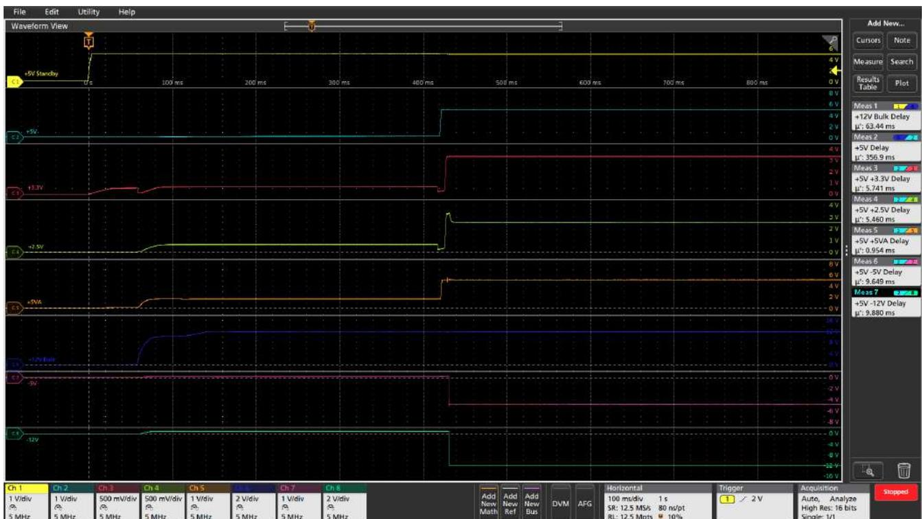
使用自動量測來分析電源供應器啟動時的特性。
