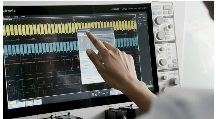
スマホやタブレットと同じ静電容量方式のタッチスクリーンを使用して操作が行える
