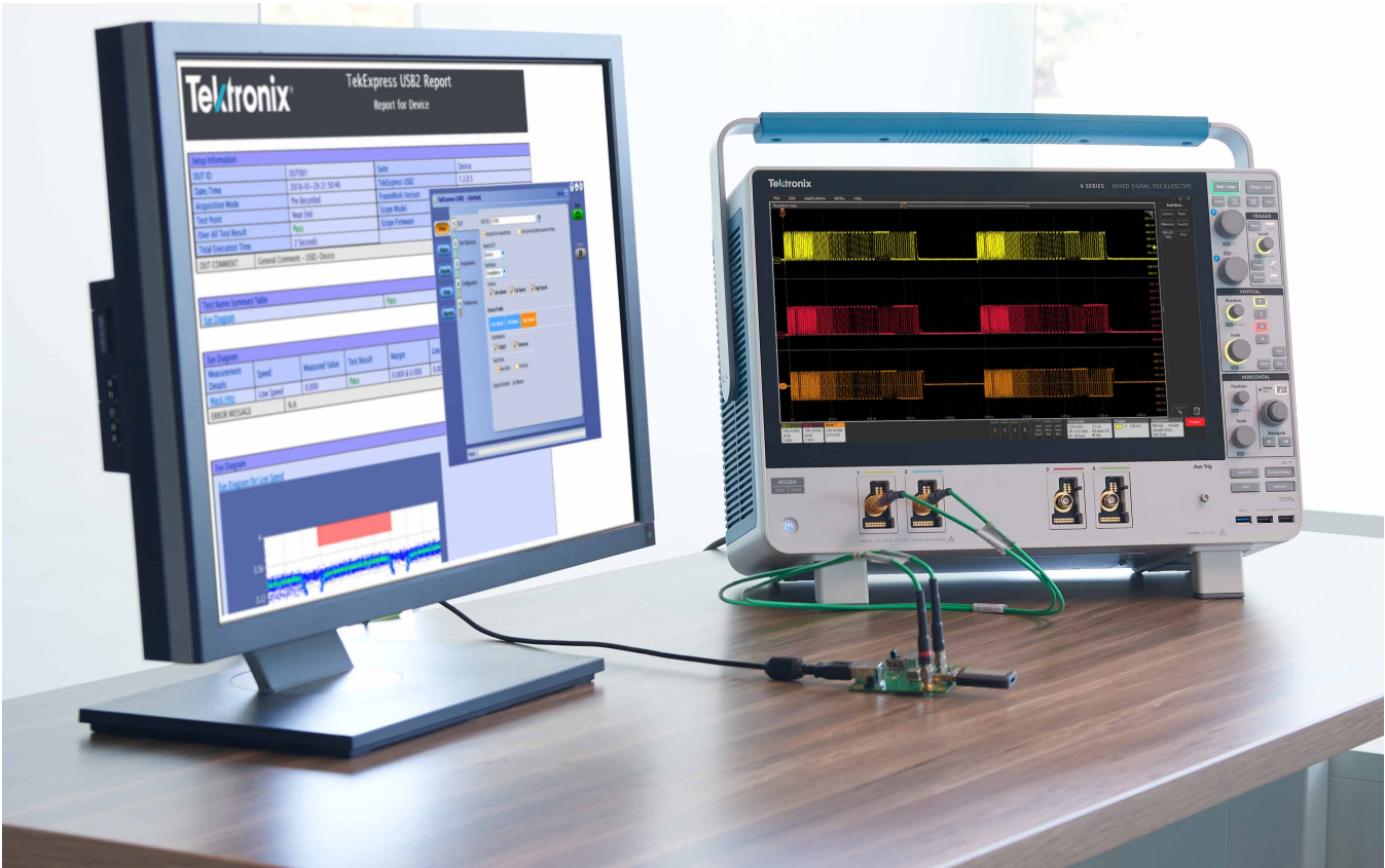
USB 2.0 仕様に準拠したコンプライアンス測定を行う 6 シリーズ MSO (Opt. 6-CMUSB2 を使用)
