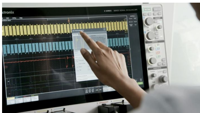
スマホやタブレットと同じ静電容量方式のタッチスクリーンを使用し、操作が行える
