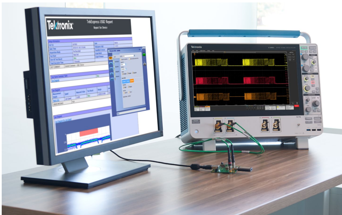
6 系統 MSO 依照 USB 2.0 規格執行 6-CMUSB2 相容性量測
