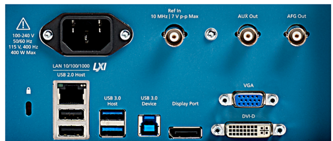
E/S nécessaire pour connecter l'oscilloscope MSO Série 6 au reste de l'environnement de conception.
