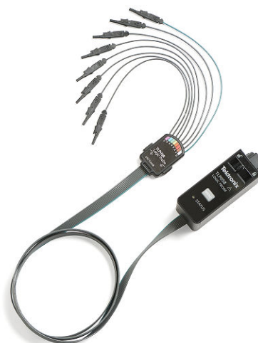
TLP058 型 : 8 つの高性能デジタル入力を装備 TLP058 型プローブは、必要に応じて何本でも接続することができ、最大 64 チャンネルのデジタル入力を利用可能
