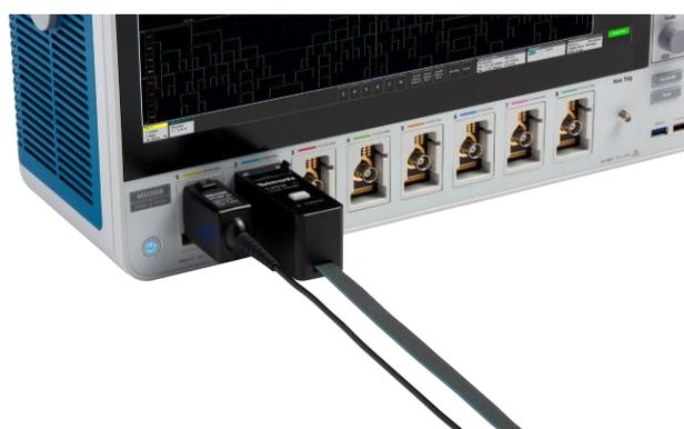
FlexChannel 技術可發揮最大的彈性。根據您接上的探棒類型，每個輸入可配置成單一類比通道，或八個數位通道。
