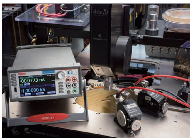
複数台のソースメータによる、ウエハまたはパッケージングされたトランジスタの特性評価
