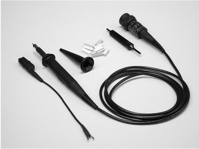
Tektronix 패시브 프로브 솔루션은 베이직 오실로스코프 측정 시 높은 신뢰성 및 테스트 정확성을 제공합니다. P2220 및 P2221은 선택한 Tektronix 오실로스코프에서 사용하도록 설계된, 1X/10X 감쇠 중 선택 가능한 소형 패시브 프로브입니다.
