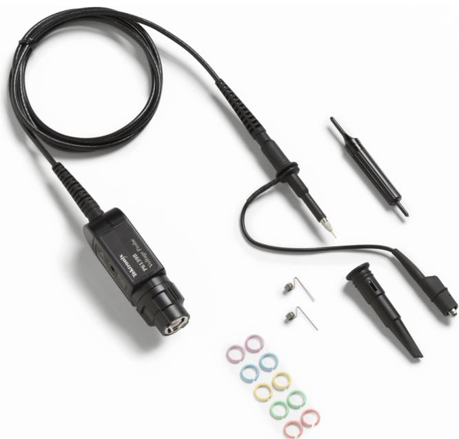
P6139B 型、P5050B 型は、10M $\Omega$  入力抵抗、広帯域、高インピーダンスの 10 : 1 受動電圧プローブです。小さなプローブ・ヘッドと鋭いヘッド・ピンは、集積密度の高い回路での使用に最適です。P6139B 型と P5050B 型は電気仕様は共通ですが、テクトロニクスでの補正レンジが異なります。ご使用のオシロスコープに適した選択については、*Oscilloscope Probe & Accessory Selector Tool* ([jp.tek.com/probes](http://jp.tek.com/probes)) を参照してください。
